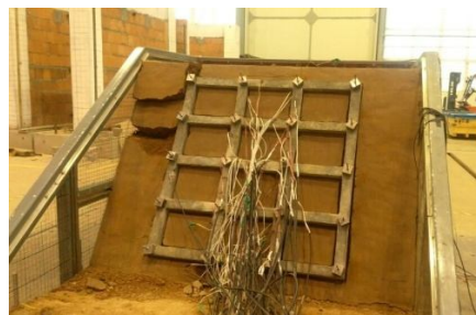
图 8 0.8 g 时模型破坏示意图 Fig.8 Damage model at 0.8 g
